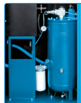
Sistema di separazione aria-olio.
