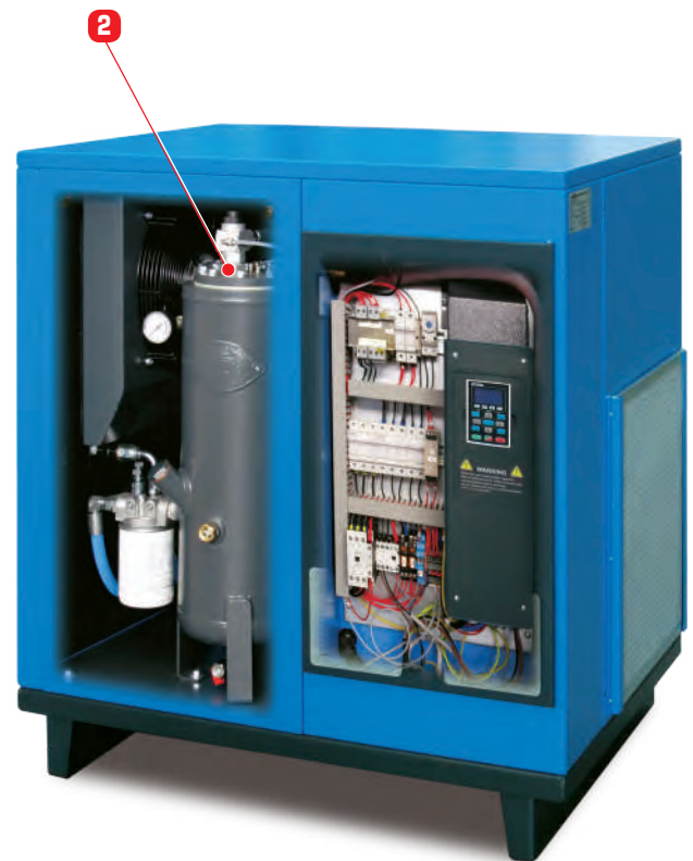
2 Sistema di separazione aria-olio.
