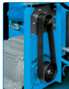
Trasmissione a cinghia Poly-V.
