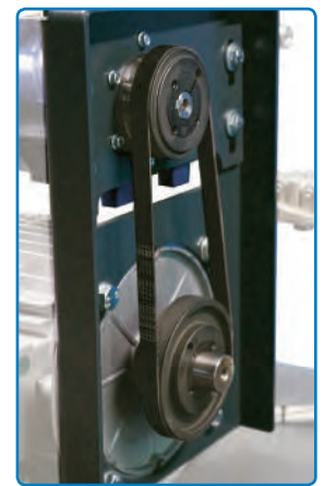
Trasmissione a cinghia Poly-V.
